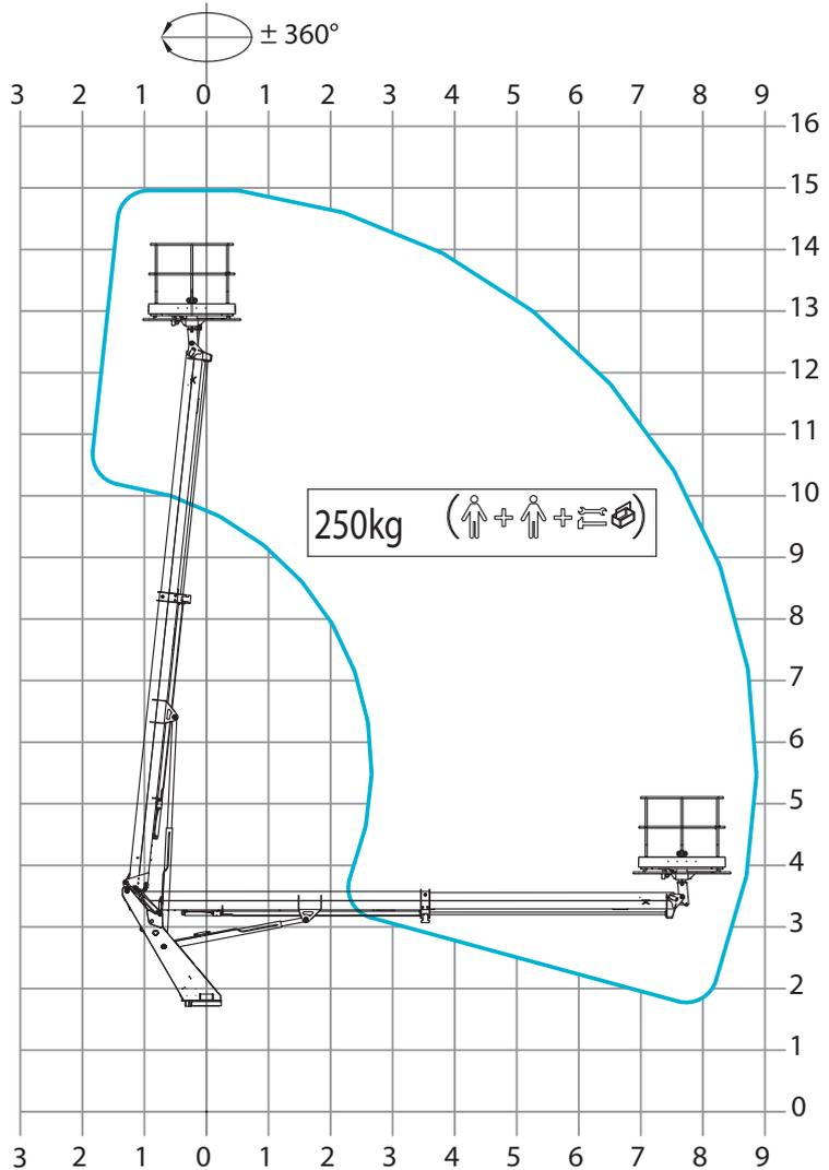
\* Los valores de alcance y altura de trabajo y su repetitividad pueden cambiar dentro de  $\pm 3\%$  debido a variaciones de fabricación y condiciones de trabajo del usuario.
