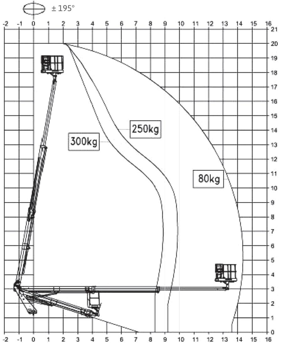
\* Los valores de alcance y altura de trabajo y su repetitividad pueden cambiar dentro de  $\pm 3\%$  debido a variaciones de fabricación y condiciones de trabajo del usuario.
